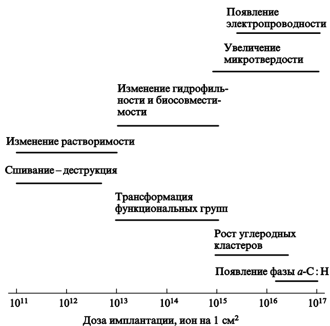
Рис. 8. Основные превращения в имплантированном слое и связанные с ними изменения физических и химических свойств в условиях облучения полимерной поверхности различными дозами ионов с энергией 0.1 – 1 МэВ.
